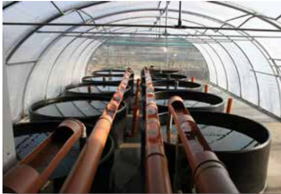
Abbildung 2: Aufsicht auf eine der verwendeten Brutmaschinen. Die Brutkörbe werden in die Aussparungen der PVC Platte eingehängt. Ein Elektromotor sorgt für eine stete Bewegung der Brutkörbe in der wassergefüllten Wanne, und stellt so die Versorgung der Eier mit frischem Wasser sicher.
